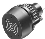
Для виступного монтажу — Ø22,5 мм, 24 В DC, IP65, 2,8 кГц, 95 дБ на відстані 0,1 м, клеми під пайку / fast-on 2,8×0,5 мм
