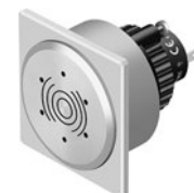
Для прихованого монтажу — Ø30,5 мм, 24 В DC, IP40, 2,8 кГц, 95 дБ на відстані 0,1 м, клеми під пайку / fast-on 2,8×0,5 мм
