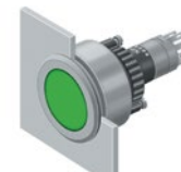
Для виступного/прихованого* монтажу в отвір Ø22,5/30,5 мм, клеми під fast-on 2,8×0,5 мм
