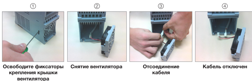
Рисунок 6.1: Снятие вентилятора радиатора охлаждения
